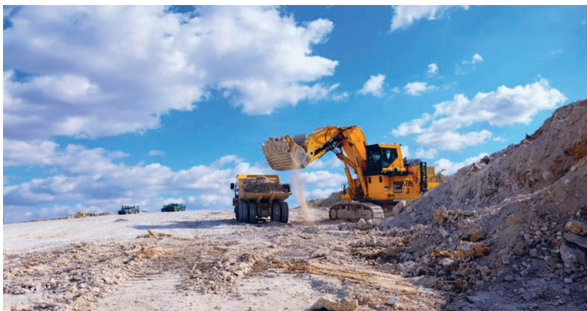
Rys. 8. Współpraca Koparki Komatsu PC 2000 z wozidłem CAT 772G.
