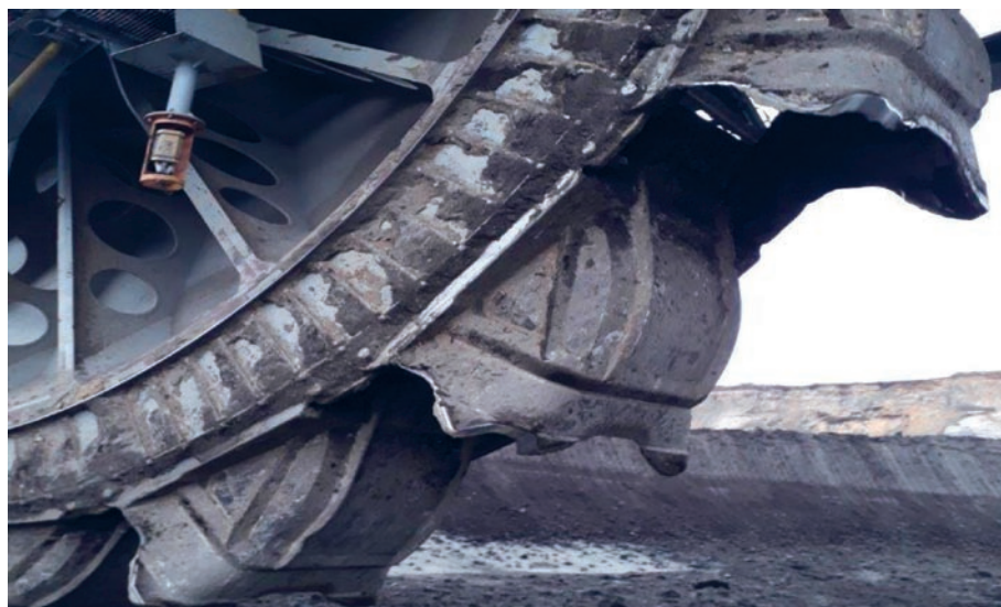
Rys. 7. Stan czerpaków koparki wielonaczyniowej po pracy w rejonie utworów trudnourabialnych.
