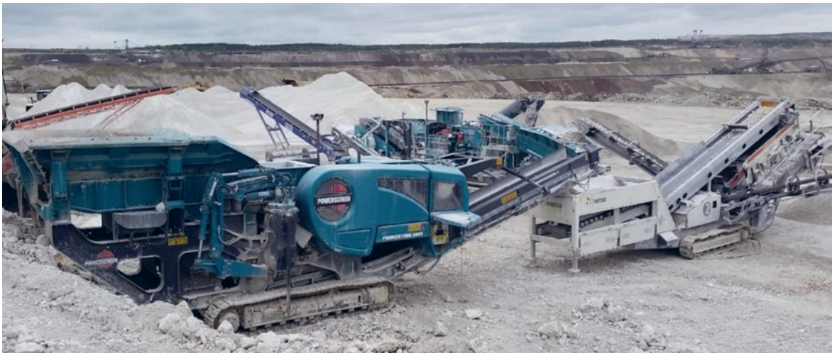
Rys. 6. Zestaw do produkcji materiału do Instalacji Odsiarczania Spalin w elektrowniach konwencjonalnych.
