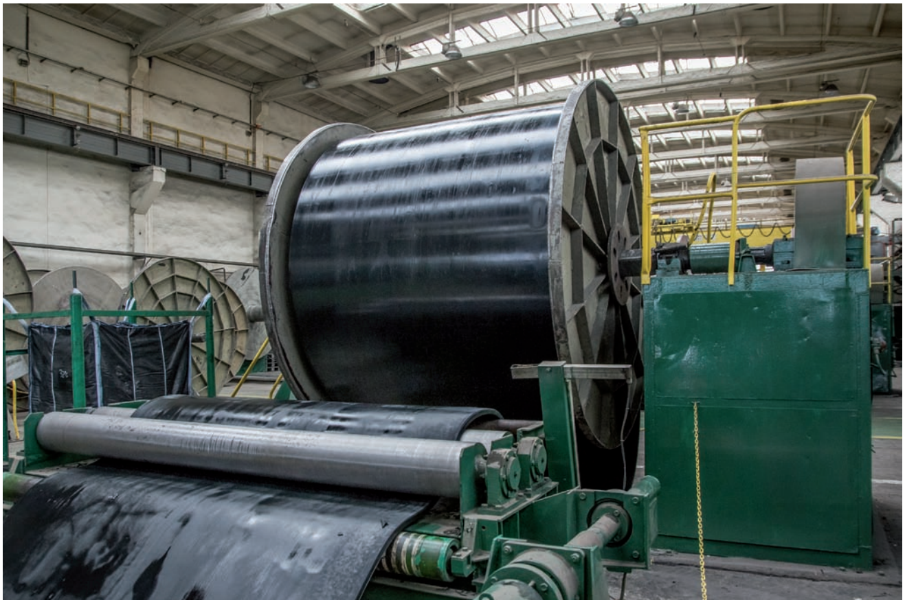
Taśma przenośnikowa z linkami po procesie regeneracji BESTGUM POLSKA.
