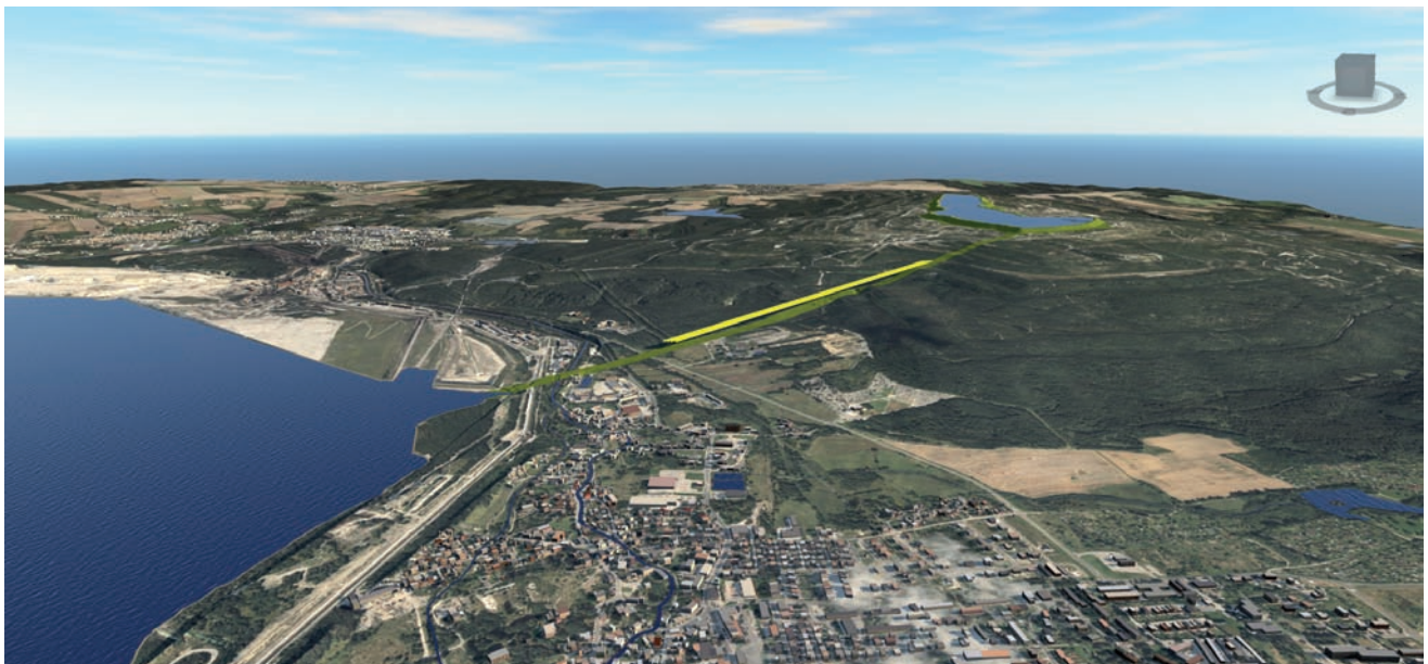
Rys. 3. Wizualizacja jednego z wariantów projektowanej elektrowni szczytowo-pompowej na przyszłych terenach po eksploatacji węgla w KWB Turów. Widok od strony Bogatyni na wyrobisko końcowe (po lewej) i zwałowisko zewnętrzne z posadowionym zbiornikiem górnym ESP (po prawej).
