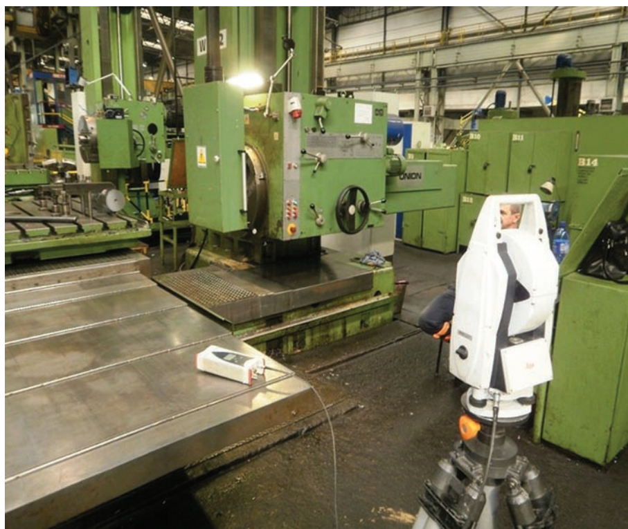
Fot. 8. Kontrola geometrii wytaczarko-frezarki WF 1/2 – pomiar położenia prowadnic kolumny w stosunku do stołu obróbkowego.
