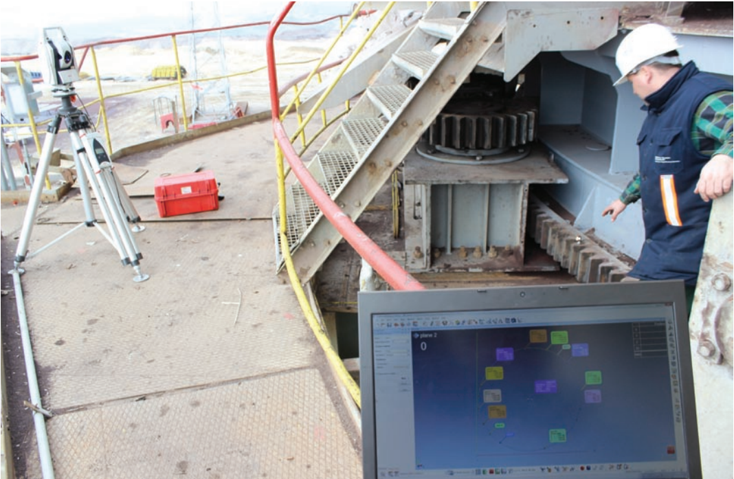
Fot. 3. Pomiar kołowości wieńca zębatego obrotu głównego i wizualizacja wyników pomiaru.
