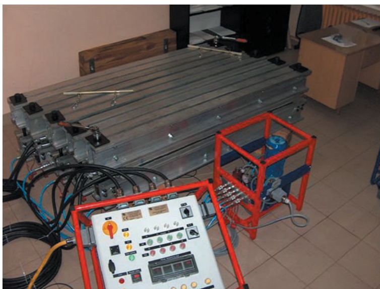
Prasa wulkanizacyjna dla taśm o szerokości do 2.250 mm z elektrycznym nagrzewaniem oporowym.
