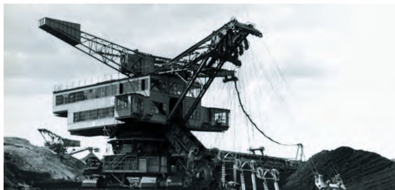
Odkrywka „Kazimierz” w roku 1967, węgiel urabia koparka Rs-560.
