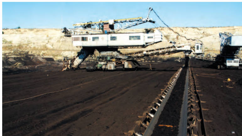
Kolejna konińska odkrywka – „Pątnów”, rok 1997, na węglu pracuje koparka Rs-400.
