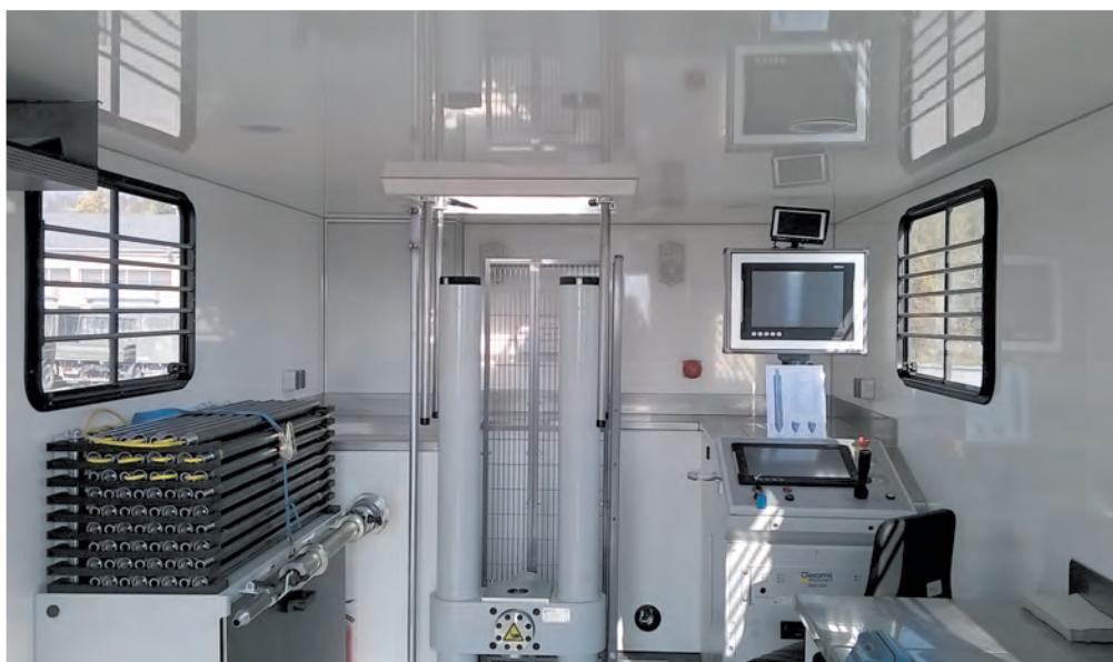
Fot. 2. Wnętrze sondy statycznej GRIZZLY 200 kN
