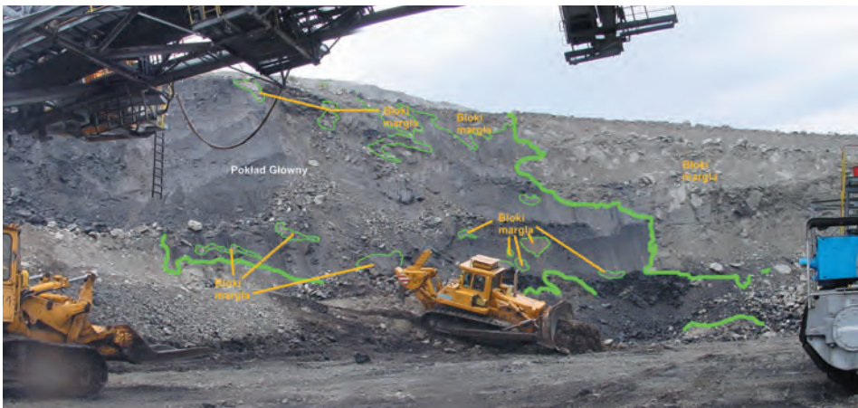
Fot. 2. Brekcja okruchowa drobnych bloczków margla w węglu pokładu głównego.
