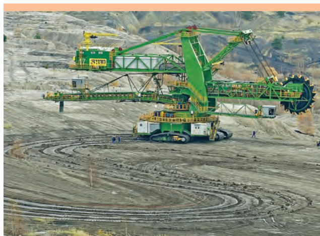
Koparka K-17 w KWB Turów, GMJ – przejazdu po łukach R=25 m.
