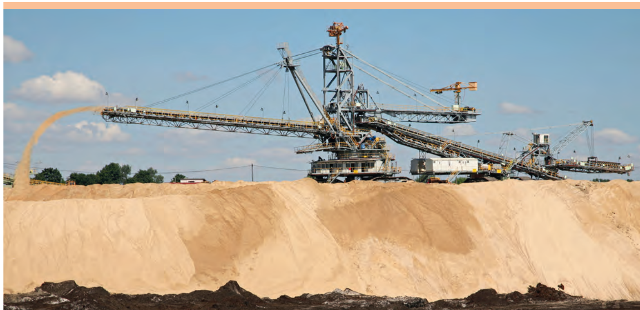
Zwałowarka A 2 RsB-5000 po modernizacji na zwalówisku wewnętrznym odkrywki „Drzewce”.
