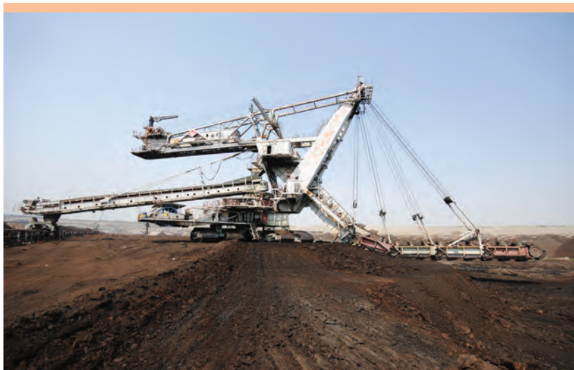
Rys. 5. Koparka łańcuchowa ERS-1000 urabiająca pokład węgla – Pole Tamnawa Zachód.
