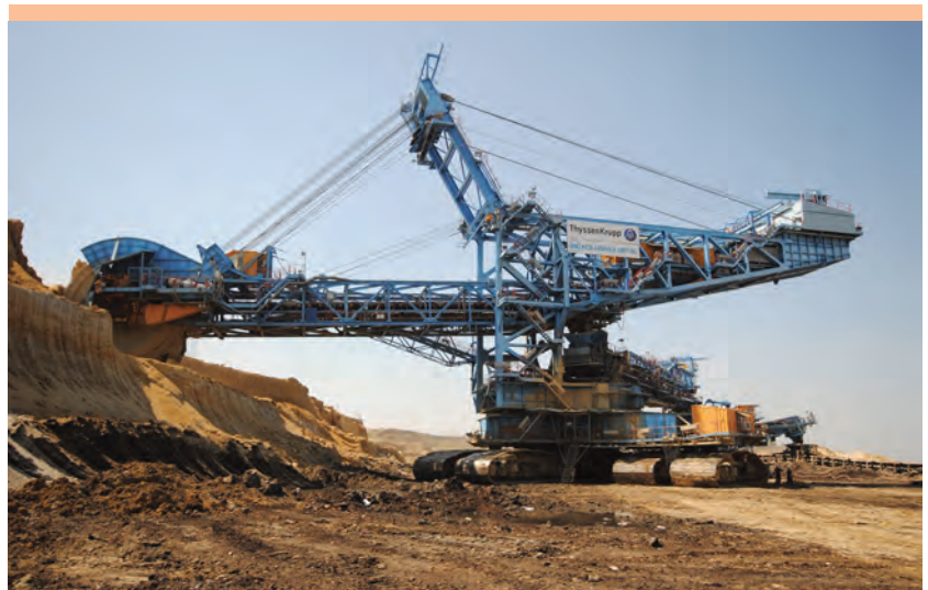
Rys. 3. Koparka SchRs-1760 urabiająca piętro nadkładowe, oddana do eksploatacji w 2010 r. – Pole D.
