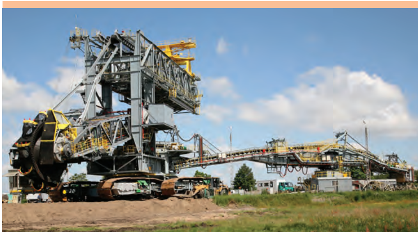
Przebudowana i zmodernizowana koparka SRs-1200/3 na odkrywce „Tomisławice”.
