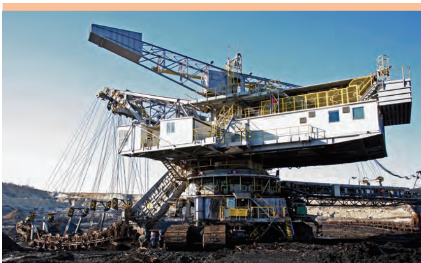
Przebudowana koparka Rs-560 (odkrywka „Tomisławice”).
