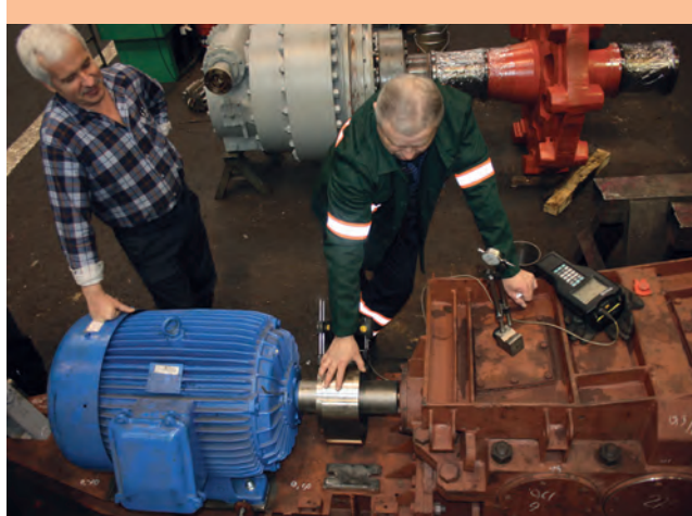
Laserowe osiowanie napędu – Krystian Leszczyk, dozorca robót i urzędzeń, Aleksander Kieraś, kontroler jakości.
