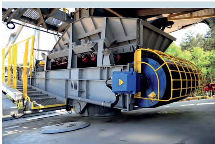
KWK-250L – napęd elektrobębnow przenośnika załadowniczego.
