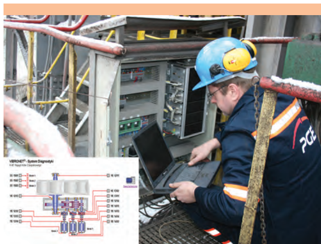
Zbieranie danych z monitoringu on-line koparki K-41 – Tomasz Michałek, mechanik maszyn i urządzeń górniczych w przodku.
