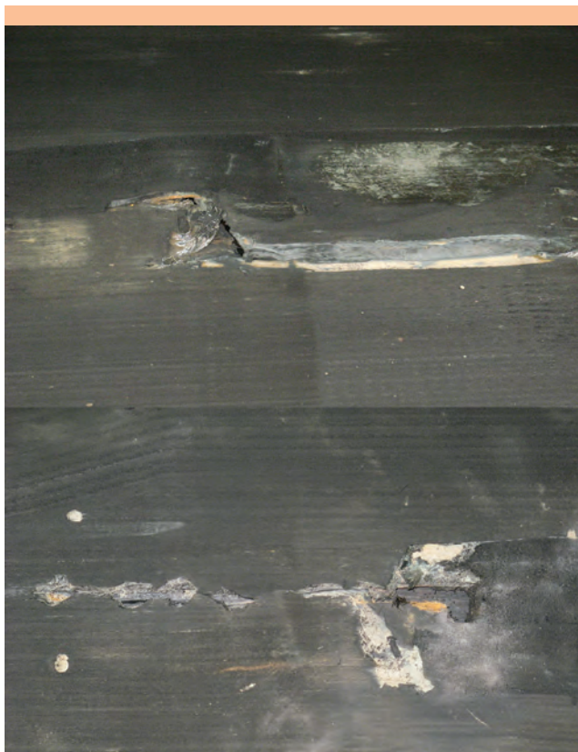
Uszkodzenie na taśmie z linkami stalowymi.
