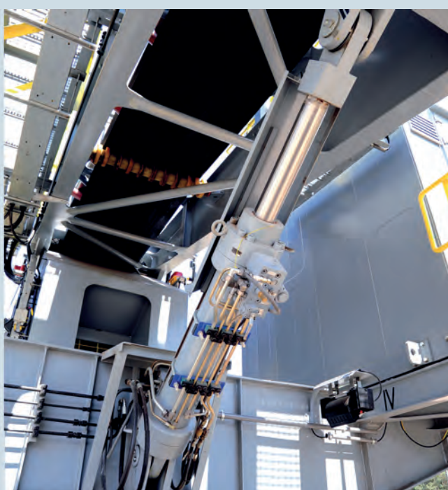
PGOT-1250.38 – zwodzenie wysięgnika odbierającego.
