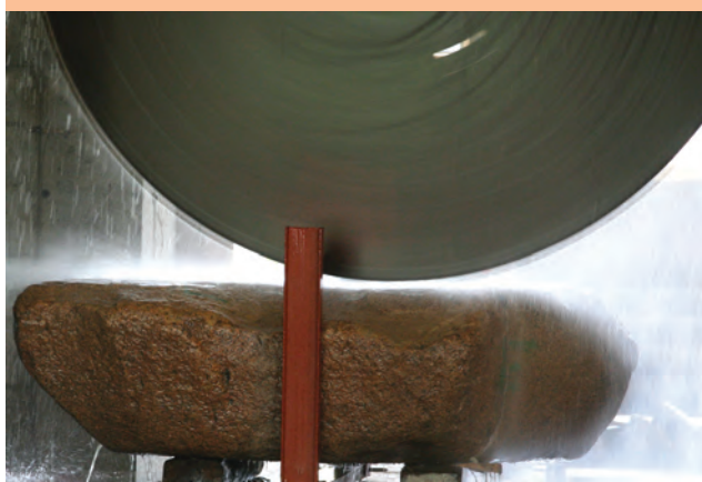
Przecinanie kamienia odbywa się w płaszczu wodnym.
