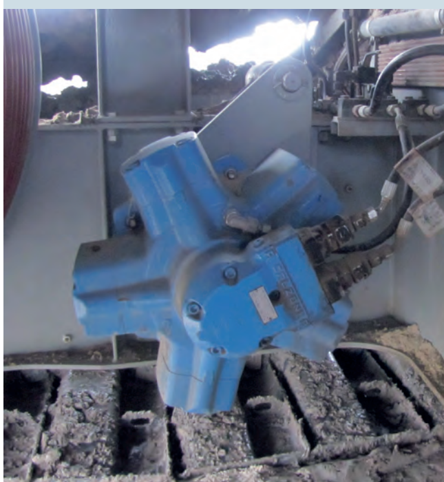
KWK-250L – napęd bębna kablowego.
