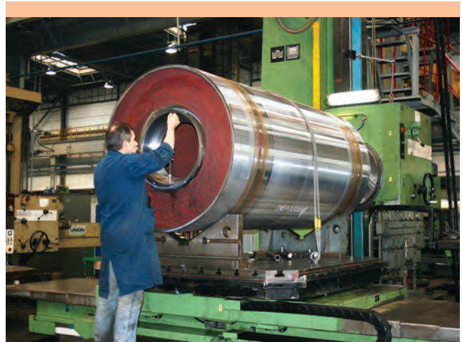
Pomiar średnicy otworu w dennicy bębna – Jan Śliwiński, kontroler jakości.
