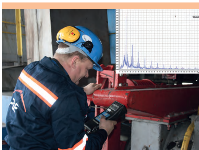
Pomiary diagnostyczne drgań – Paweł Pawłowski, mechanik maszyn i urządzeń górniczych w przodku.
