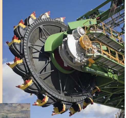
Koparka KWK-910 – zespół napędu urabiania 2 \times 500 = 1.000 kW ze specjalnymi czerpakami do utworów trudnourabialnych.
