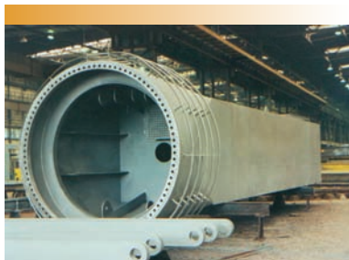
Kolumna dźwigu okrętowego.
