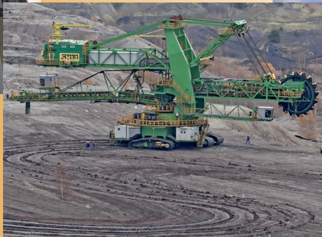
Koparka KWK-910 (mobilna) w czasie zjazdu na dolny poziom roboczy KWB Turów (promień skrętu 25 m).
