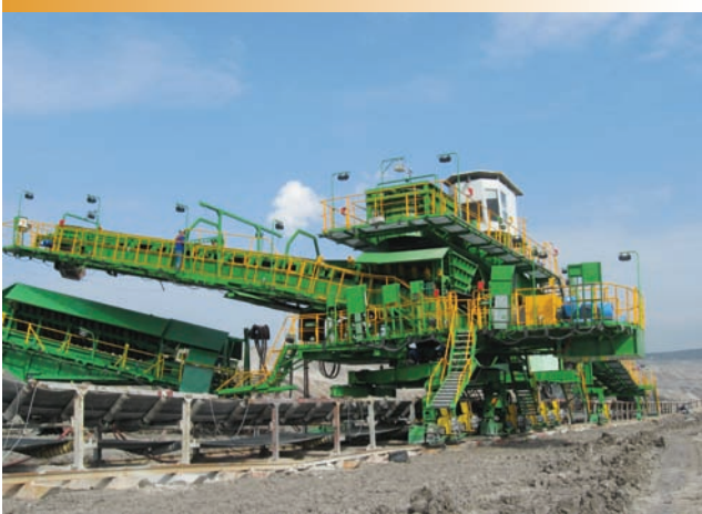
Przenośnik obrotowy i wózek zrzutowy do Z-45.
