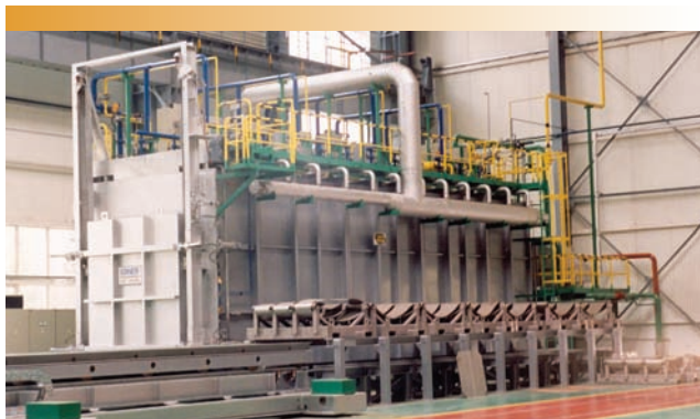
Piec do wyżarzania rulonów taśm i blach w stosach dla Huty Aluminium „Konin”.
