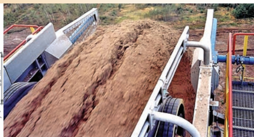
Zwałowarka ZGOT-15400.120 – próba wydajności; osiągnięto – Q=16.230\text{ m}^3/\text{h} .
