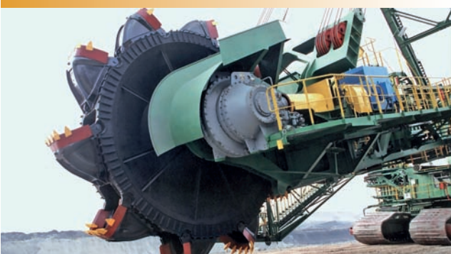
Napędy urabiania N=500 kW koparek KWK-1200M.
