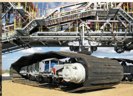
Zwałowarka ZGOT-15400.120, gąsienicowe mechanizmy jazdy B=4.200\text{ mm} w KWB Bełchatów.
