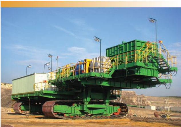
Modernizacja stacji napędowej Z6.6.
