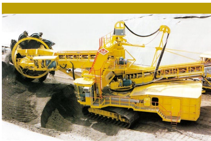
Rys. 2. Koparka kompaktowa S-400. Producent: O&amp;K (obecnie Krupp).
