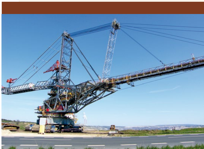
Transport zwałowarki na Pole „Szczerców”.
