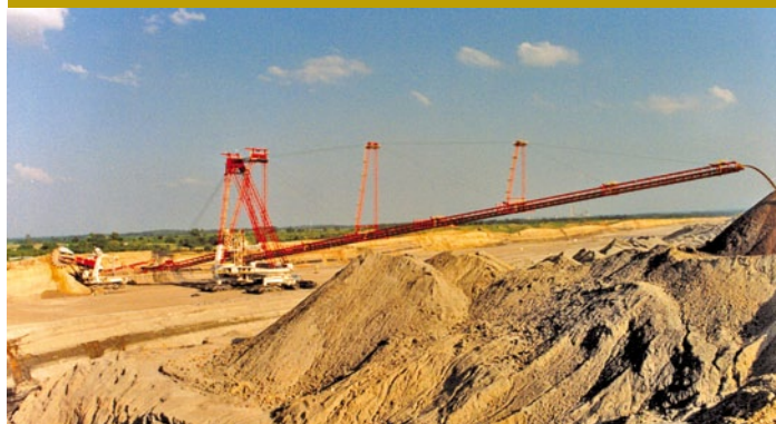
Rys. 5. Zwałowarka VACSP-6500-250/I o wydłużonym wysięgniku (260 m) współpracująca z koparką kompaktową. Producent VOEST-ALPINE (obecnie SANDVIK).
