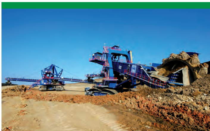
Rys. 14. Koparka i podawarka podczas urabiania na jednym poziomie poniżej poziomu przenośnika.
