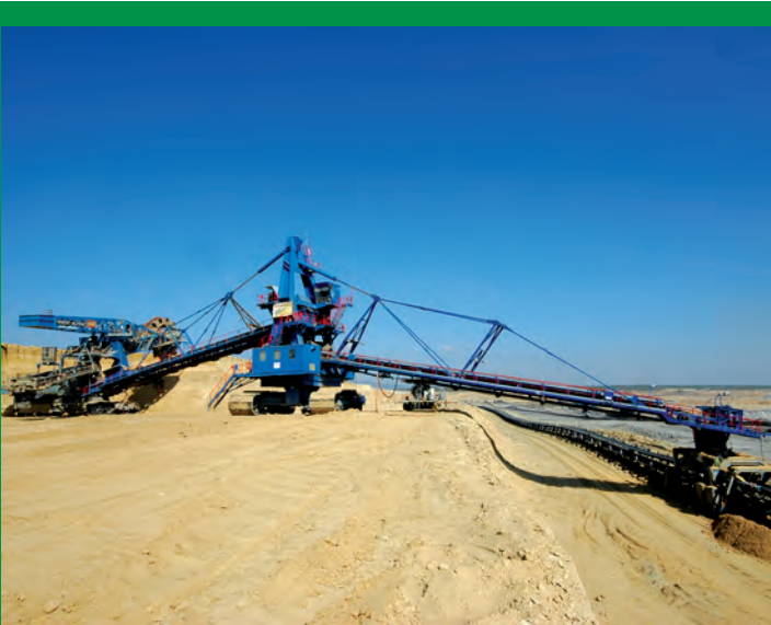
Rys. 9. Podawarka PB100-1800/30+35 w pełnym układzie.
