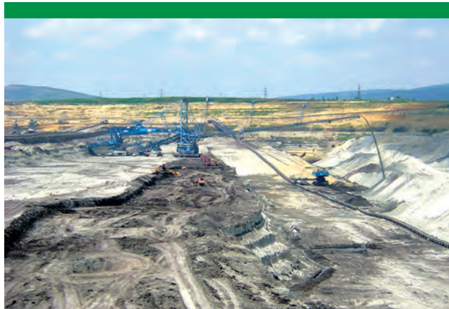
Rys. 3. Połączony układ koparka kołowa-zwałowarka oraz urabianie nadkładu przez firmę zewnętrzną koparkami jednonaczyniowymi.
