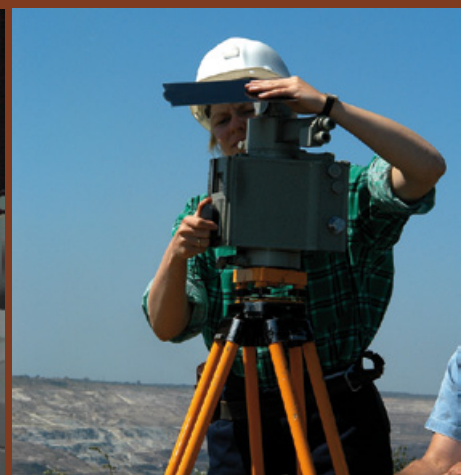
Rys. 1. Pomiar zdjęć na autografie analitycznym Stecometer C firmy Zeiss oraz rejestracja zdjęć fototeodolitem Photheo 19/1318 (fot. A. Gawin, W. Iwańców).
