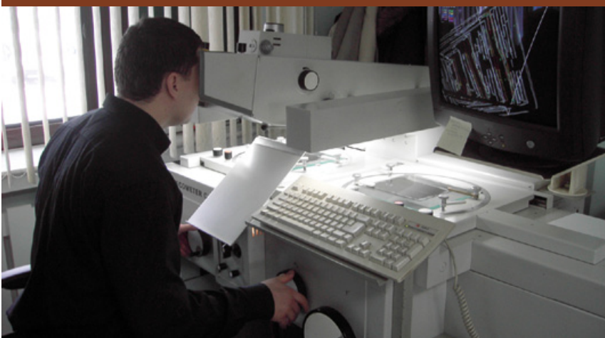
Rys. 1. Pomiar zdjęć na autografie analitycznym Stecometer C firmy Zeiss oraz rejestracja zdjęć fototeodolitem Photheo 19/1318 (fot. A. Gawin, W. Iwańców).
