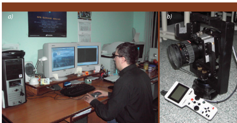
Rys. 2. System fotogrametrii naziemnej: a) cyfrowa stacja fotogrametryczna Dephos, b) kamera metryczna AIC Modular LS P45 firmy Rollei. (fot. Anna Gawin)
