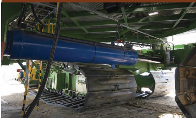
Hydrauliczne sterowanie gąsienic.
