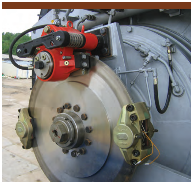
Sprzęgło przeciążeniowe szybko „odcinające” nadwyżki dynamiczne procesu urabiania.
