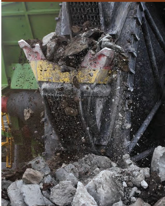
Czerpaki z narożami odlewanymi głębokohartowanymi.
