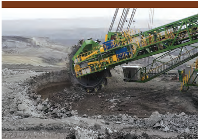
Praca koparki w utworach trudnourabialnych.
