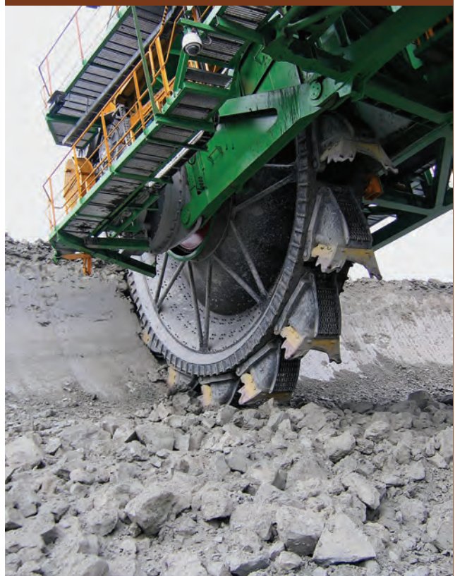
Praca koparki w utworach trudnourabialnych.
