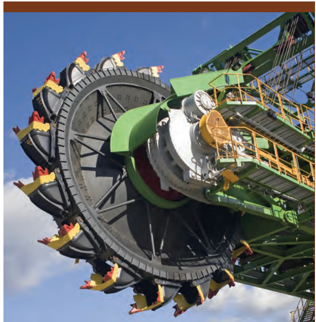
Układ urabiania z zespołem napędowym 2x500 kW.
