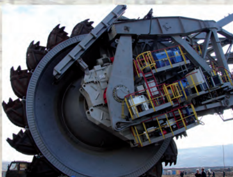
Zmodernizowany zespół urabiający koparki SRs-2000.
