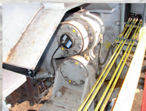
Otwierana hydraulicznie kłapa w leju koła czepakowego.
