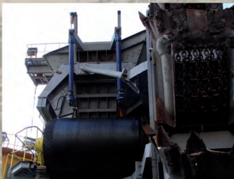
Tylne zawieszenie przekładni koła czepakowego z tensometrycznym sworzniem pomiarowym.
