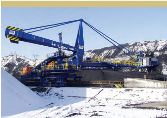
Ładowarko-zwałowarka ŁZKS-500.29,5, Fugo SA / KWB „Konin” SA. Zdjęcie podczas pracy maszyny tego samego typu.
