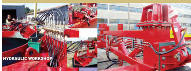
Prefabrykacja instalacji hydrauliki siłowej.
