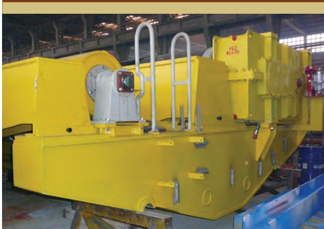
Wciągarka suwnicy pomostowej o udźwigu 500 T, Dozamel Wrocław.
