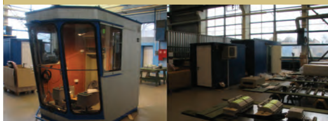
Prefabrykacja kabin sterowniczych i kontenerów wyposażenia elektrycznego.
