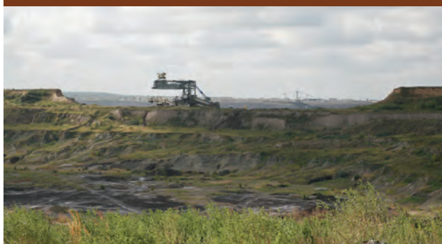
Widok na „Kazimierz” od strony „Józwina”. Koparka SRs-1200/3 przekopowała już pierwszą warstwę filara dzielącego odkrywki.
