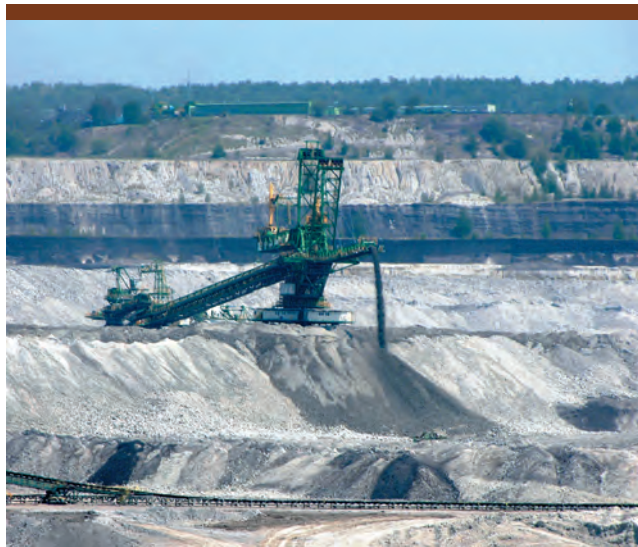
Zwałowarka Z-47 na froncie północnym zwałowiska wewnętrznego. Poniżej zwałowarki widoczny przenośnik podzwałowy Z-45.
