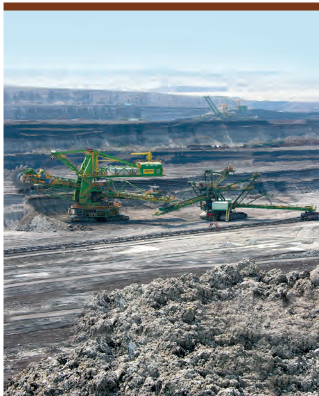
KWK-910 nr 17 na poziomie +50 m współpracuje z przenośnikiem samojedźnym PGOT-4500 w rejonie uskuu głównego.
