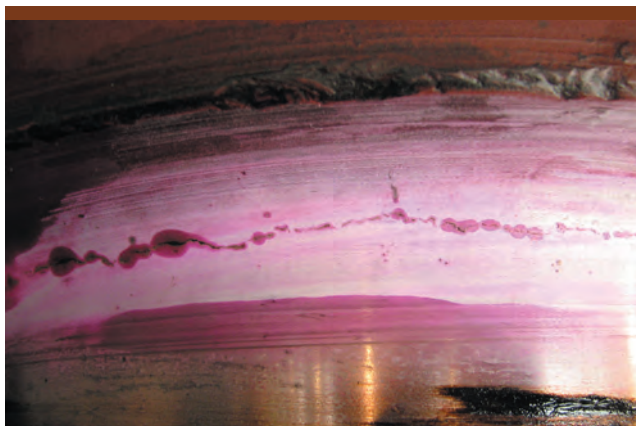
Pęknięcie czopu wieloboku napędowego mechanizmu jazdy koparki SRs-1200 wykryte przy użyciu metody penetracyjnej.
