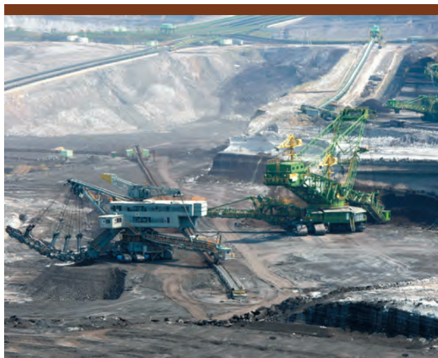
Koparki K-30 (Rs-560) i zmodernizowana K-27 (KWK-1200M) na poziomie +25 eksploatują węgiel I pokładu.
