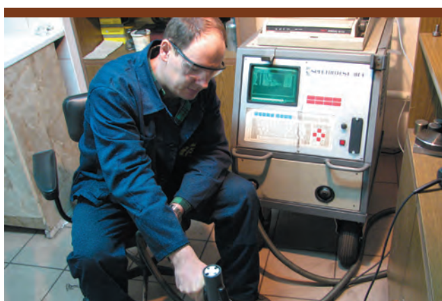
Kontrola dostaw zewnętrznych – badanie składu chemicznego metali przy pomocy analizatora Spectrotest JRF.
