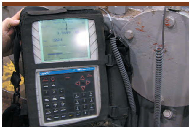
Diagnostyka wibroakustyczna przekładni zębatej przy pomocy analizatora drgań Mikrolog CMVA 55.
