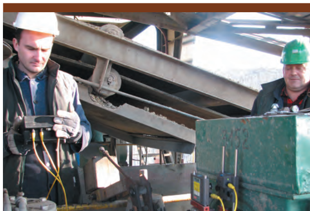
Ustawianie współosiowości wałów zespołu napędowego przy pomocy systemu laserowego Combi-Laser.
