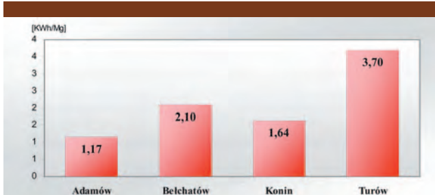
Rys. 8. Średni wskaźnik energochłonności liczony na wydobytą masę plus ilość wypompowanej wody dla poszczególnych kopalń.
