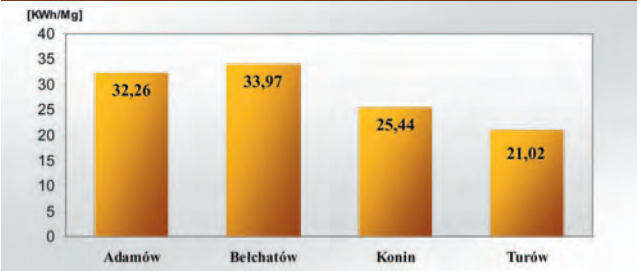
Rys. 7. Średni wskaźnik energochłonności liczony na jednostkę wydobytego węgla dla poszczególnych kopalń.
