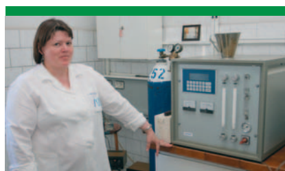
Laborantka przy automatycznym analizatorze zawartości siarki w węglu.
