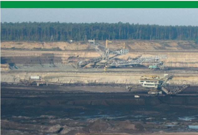
Rys. 2. Odkrywka „Lubstów” – widok północnej części przyszłego zbiornika końcowego (na drugim planie koparka KWK-1500s urabiająca drugie piętro nadkładowe).
