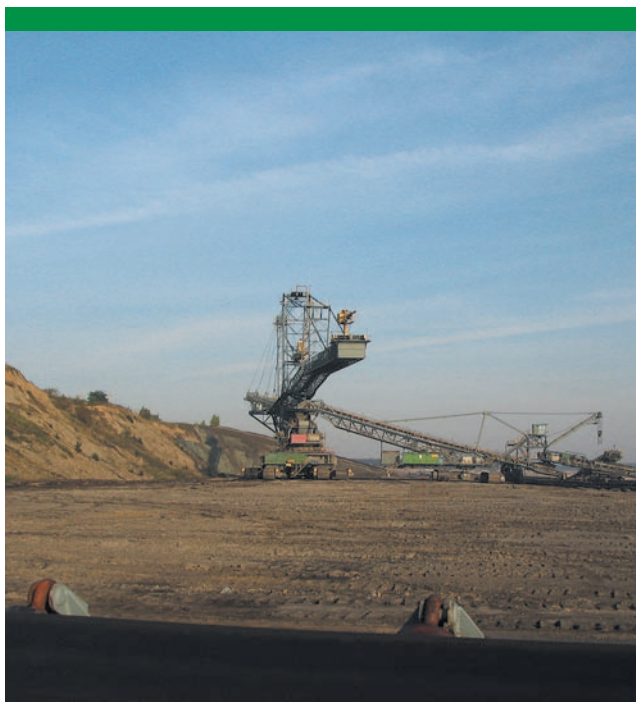
Rys. 5. Odkrywka „Lubstów” – kształtowanie zachodniej skarpy zbiornika końcowego zwałowarką A 2 RsB-8800.
