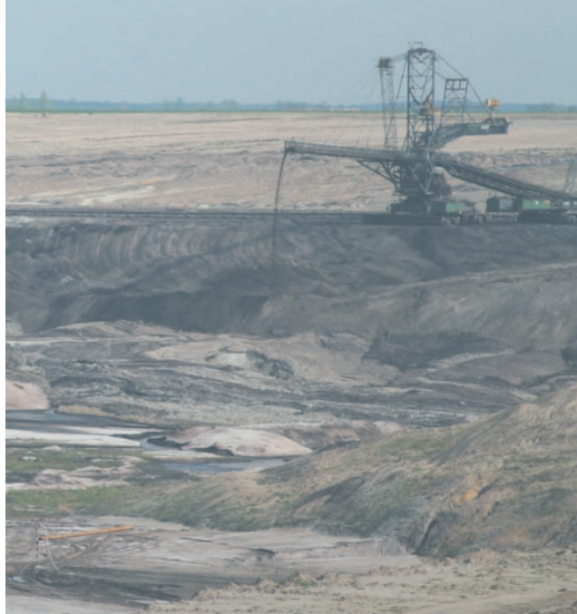
Rys. 5. Odkrywka „Lubstów” – kształtowanie zachodniej skarpy zbiornika końcowego zwałowarką A 2 RsB-8800.
