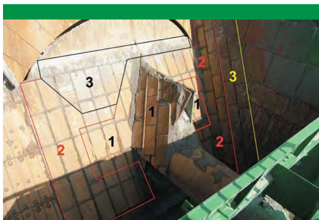
Rys. 1. Obszary o różnej intensywności zużycia ściernego zsuwni stałej w przesypie koła czerpakowego koparki KWK-1500s. 1 - obszar maksymalnego zużycia, 2 - obszar średniego zużycia, 3 - obszar minimalnego zużycia ściernego zsuwni [13].
