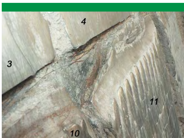
Rys. 6. Makroskopowy stan powierzchni zsuwni po przetworzeniu 565 godz. Powiększenie obrazu zaznaczone ramką na rysunku 5 [13].
