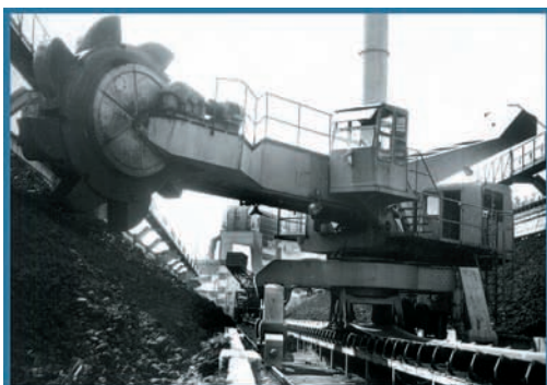
Ładowarka ŁWK-251 – jedna z pierwszych wykonanych w Famaku.
