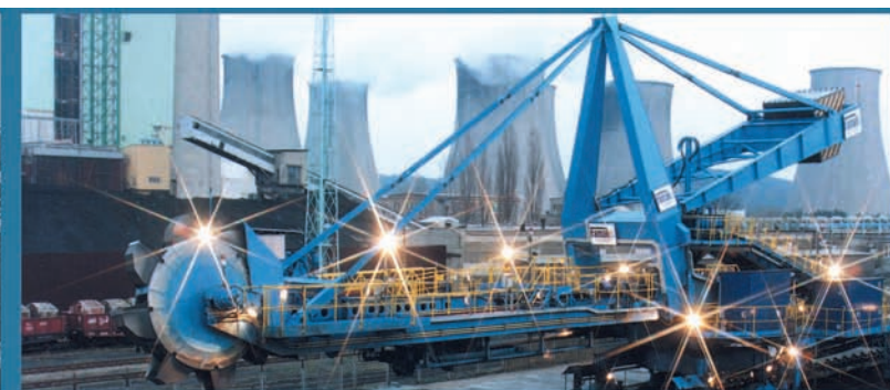
Ładowarko-zwałowarka ŁZKS 250.25/31.5 w Elektrowni Siersza S.A.
