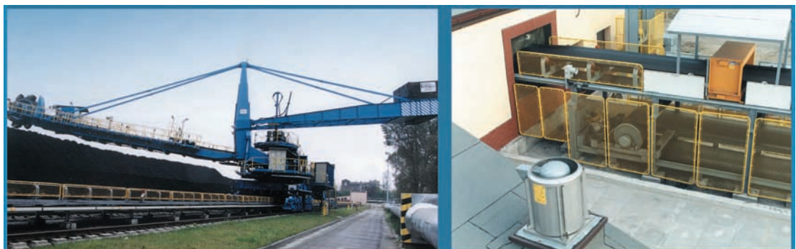
Ładowarko-zwałowarka ŁZKS-200.25/31,5 i fragment systemu przenośników z separatorem magnetycznym.
