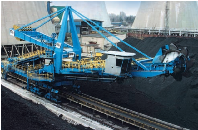
Ładowarko-zwałowarka ŁZKS-250.25/31.5 w Elektrowni ŁAGISZA S.A.
