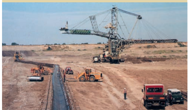
Odkrywka „Kazimierz” pracuje od 1965 roku, czyli od 40 lat. Na zdjęciu przenośnik G-2, w tle zwalowarka A 2 RSB-8800.
