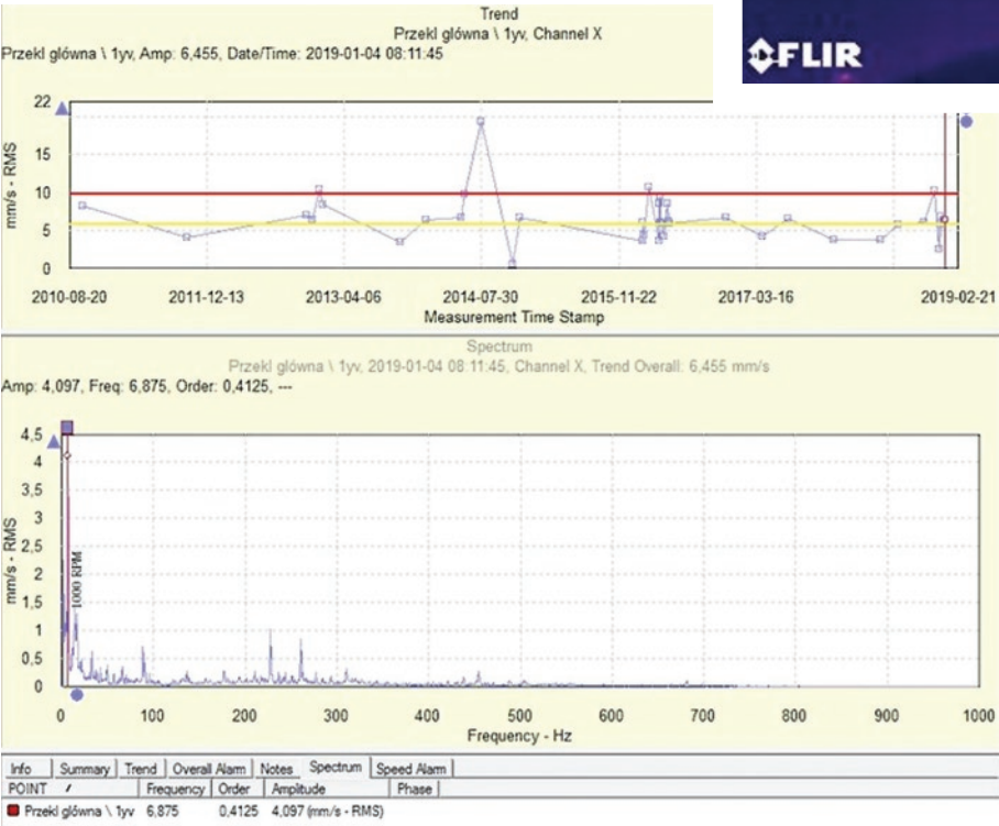
Rys. 17. Badania wibroakustyczne: wykres z mikrologa SKF przedstawiający widmo drgań przekładni głównej koła czerpakowego koparki SRs 1800/2.
