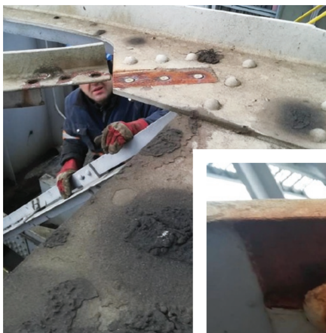
Fot. 10 i 11. Uszkodzony pręt skośny na wysięgniku T-1 koparki SchRs 1200/6.
