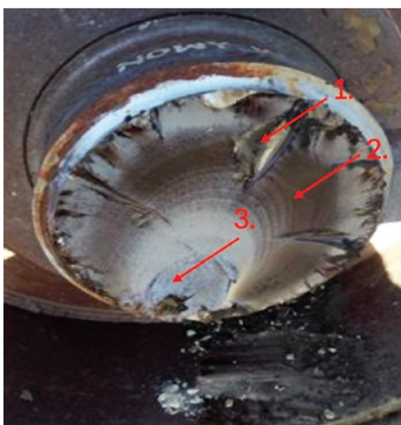
Fot. 8. Uszkodzony wał bębna napędowego przenośnika T-1 koparki SchRs 1200/1.
