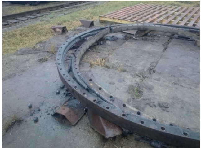
Fot. 3. Łoże kulowe T-2 koparki SchRs 900 po demontażu.
