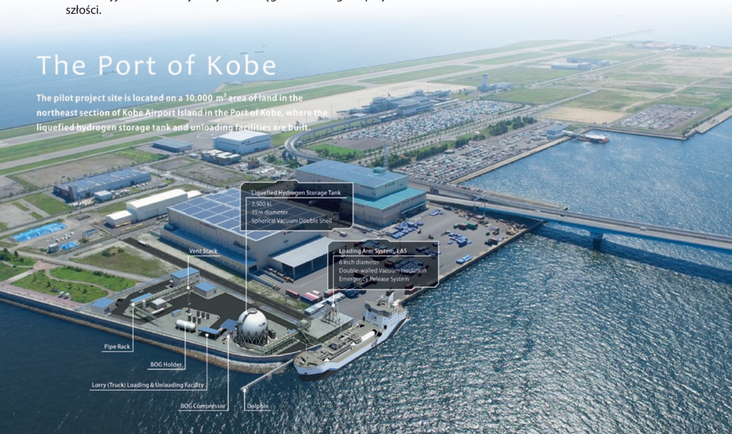
Rys. 5. Wizualizacja instalacji do rozładunku skroplonego wodoru w porcie w Kobe w Japonii [1].
