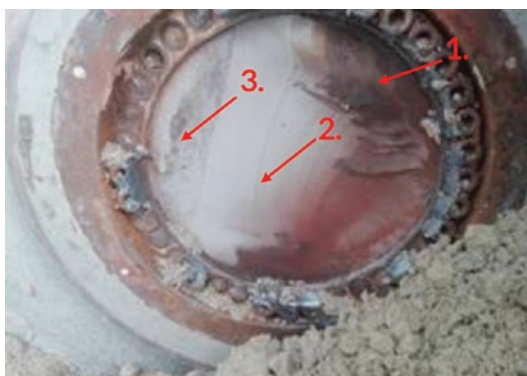
Fot. 7. Uszkodzona oś bębna zwalówki A 2 RsB 8800/2.
