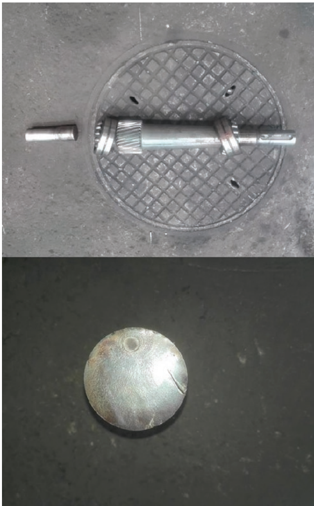
Rys. 20. Badania ultradźwiękowe (UT): przełom pękniętego wałka napędu zwodzenia kabiny operatora na koparce KWK 1500s.
