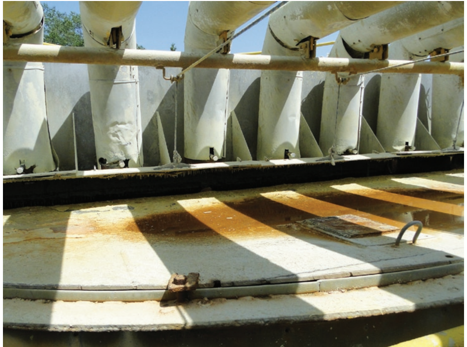
Sesja terenowa w kopalni siarki „Osiek” – wypływ siarki z rury końcowej do zbiornika na polu górniczym.
