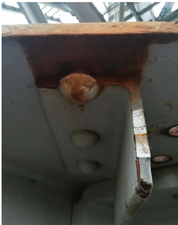
Fot. 10 i 11. Uszkodzony pręt skośny na wysięgniku T-1 koparki SchRs 1200/6.
