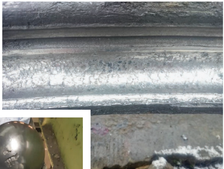
Fot. 4. Rozwalcowaną powierzchnię bieżni łoża T-2 koparki SchRs 900.
