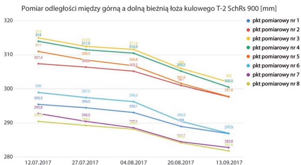
Fot. 6. Postęp degradacji łoża kulowego T-2 koparki SchRs 900.
