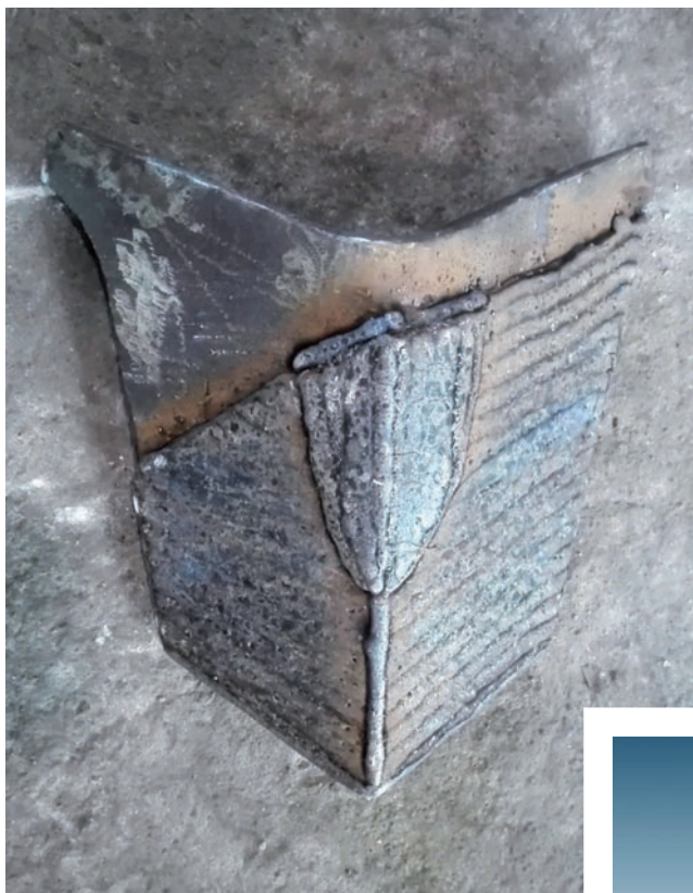
Fot. 4. Czerpak koparki SRs-1800 po modernizacji oraz napawane naroże.
