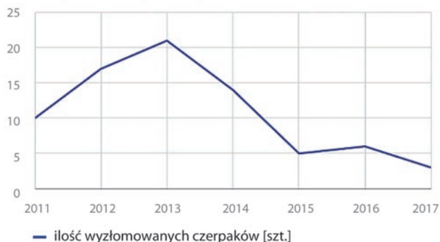
Fot. 6a i 6b. Wpływ modernizacji na zużycie czerpaków koparki SRs-1800.
