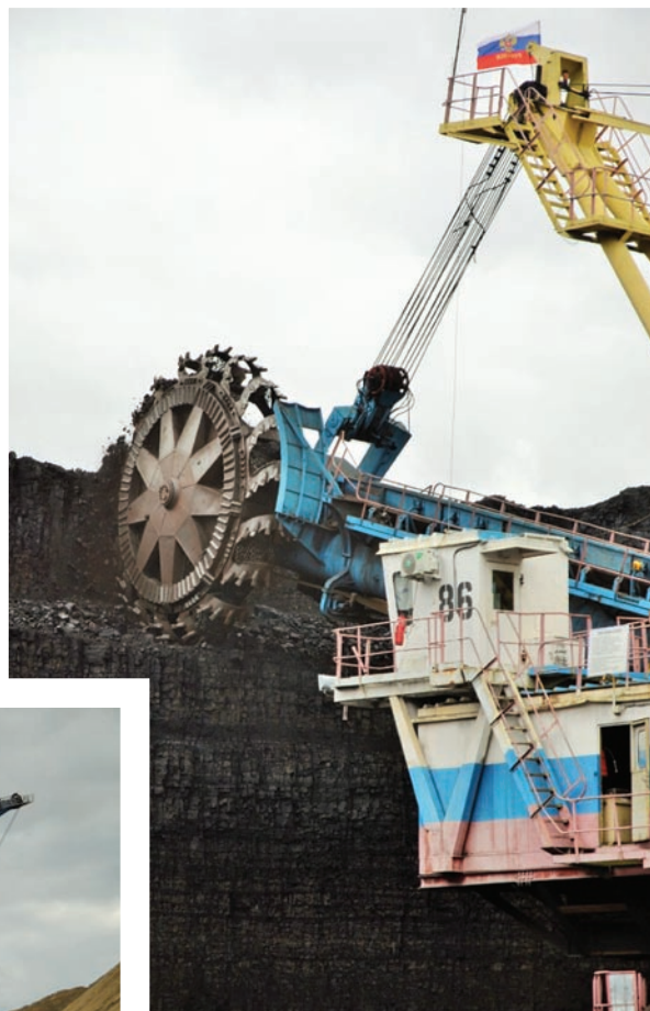
Rys. 17. Koło urabiające koparki ER-1250) (rozładunek odśrodkowy).
