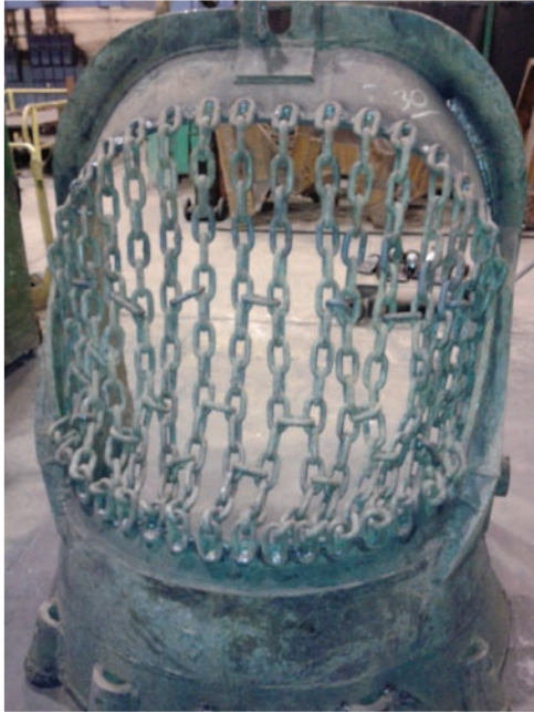
Fot. 7a i 7b. Czerpak koparki SRs-1200 przed i po modernizacji.
