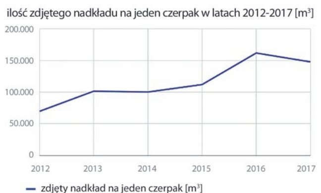
Fot. 9. Wpływ modernizacji na wydajność czerpaków koparki SRs-1200.
