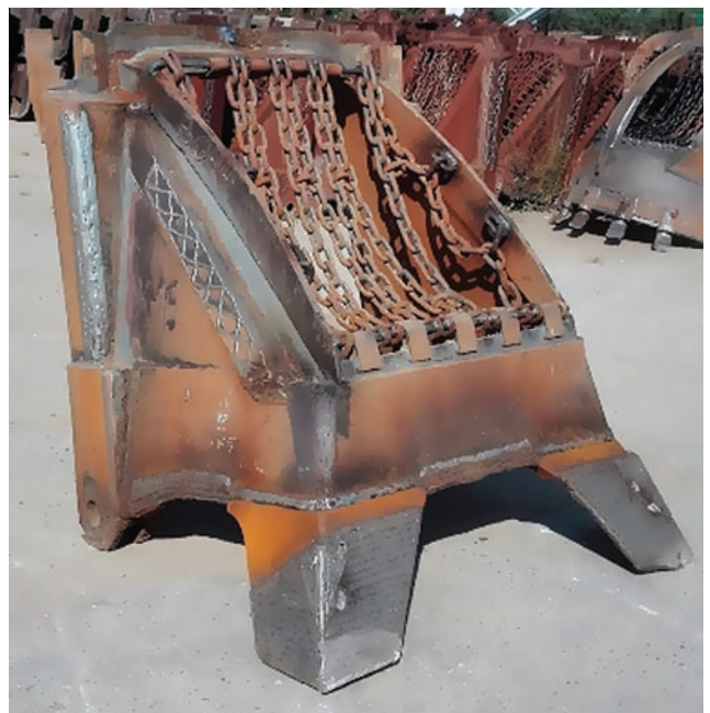
Fot. 3a i 3b. Czerpak koparki SRs-1800 przed i po modernizacji.
