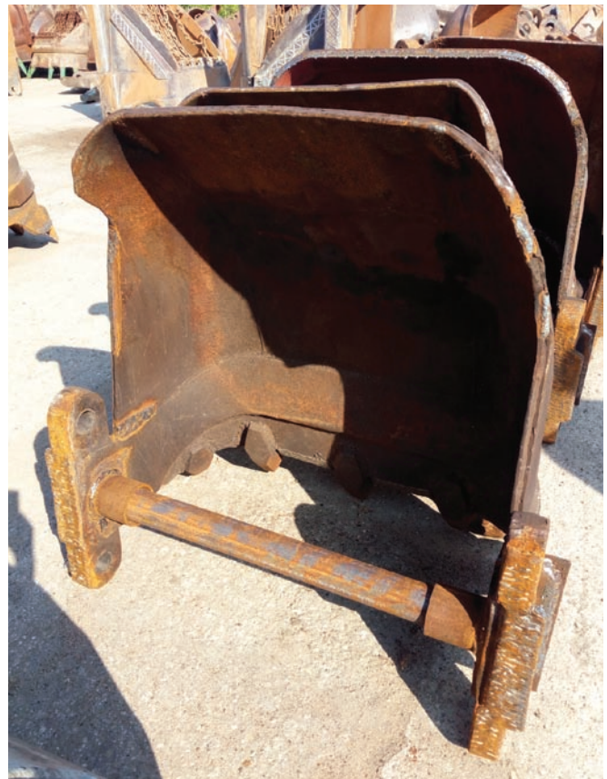
Fot. 13a i 13b. Czerpak koparki Rs-560 z poprzeczką spawaną z dwóch kątowników oraz z poprzeczką rurową spawaną.
