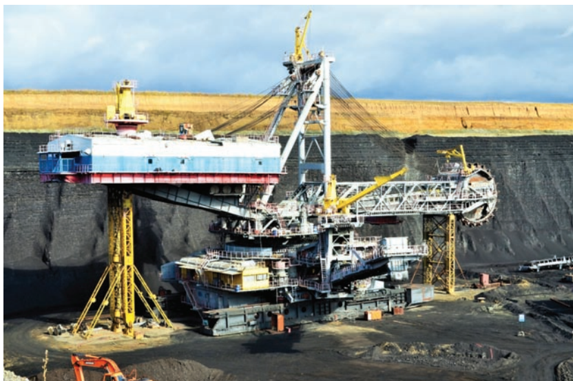
Rys. 5. Koparka ERSHR-5250 – zdjęcie podczas remontu.
