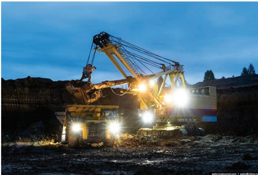
Rys. 24. Załadunek nadkładu koparką EKG-10 na wozidło Komatsu.
