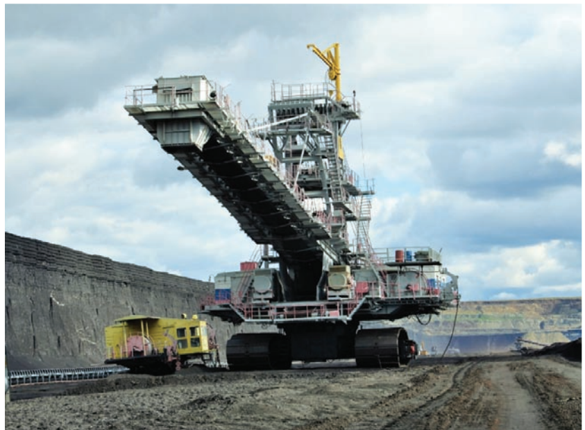
Rys. 10. Widok PGOT-a na podwoziu gąsienicowym.
