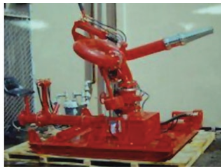
Rys. 2. Przykładowy schemat testu stanowiskowego hydro-urabiania kalizny węglowej w warunkach Kopalni Doświadczalnej „Barbara” oraz przykład „działka wodnego” i test zasięgu strugi wody (hydro-urabianie).
